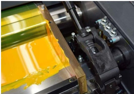
Schmierung Walzenlager und Seitenbacke Farbkasten mit ELKALUB GLS 964/N2
