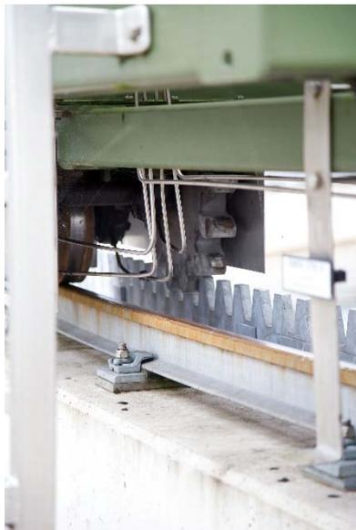
Schienenlaufrolle mit Zahnradantrieb
